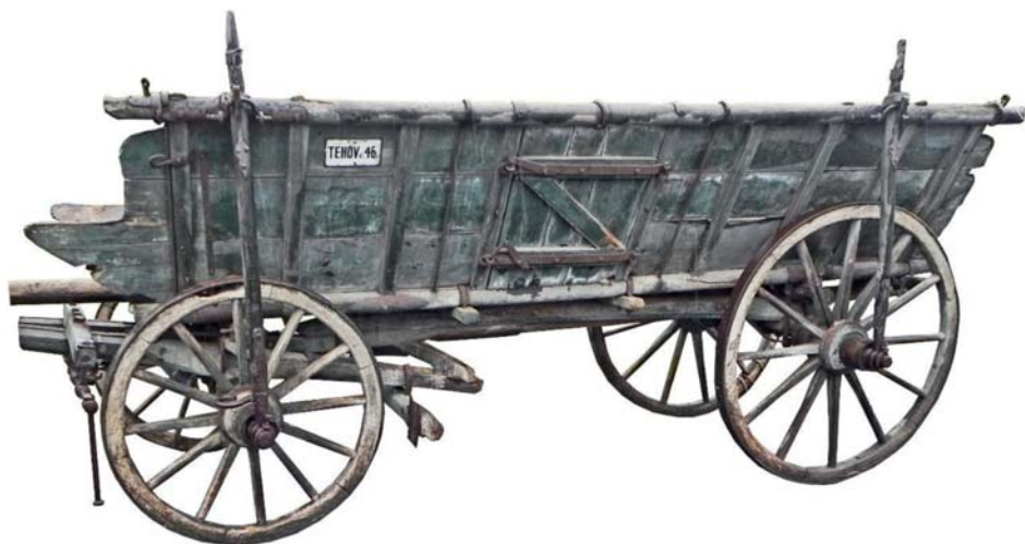
Fasuňek - vůz s plnými bočnicemi na převoz kamení, zeminy, brambor apod.
